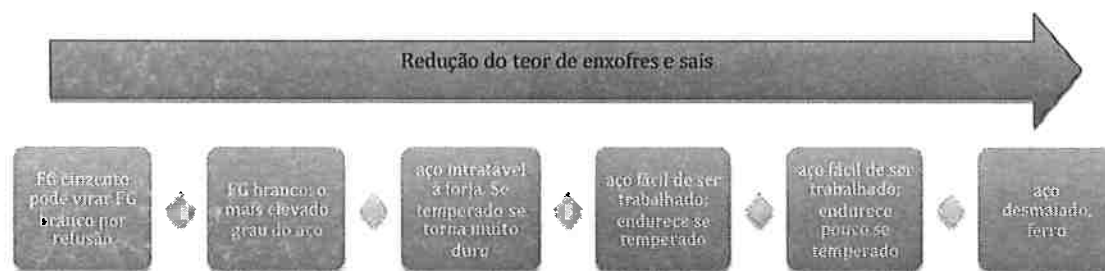
Figura 16: Os vários estágios do refino segundo Réaumur, 1722 [18, p. 775]
